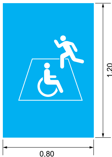
Figura 64 – Área de resgate para pessoa com deficiência
